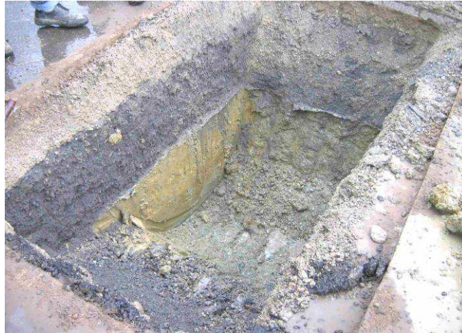
Photo 1 : Interface entre la couche de MIOM et le sol sous-jacent
