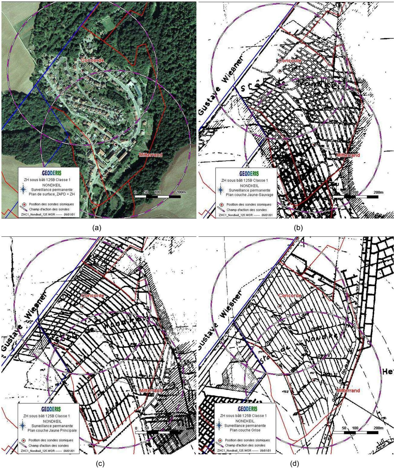
Figure 6 – Stot d'Ottange-Nondkeil. Réseau de surveillance microsismique : (a) Implantation et rayon d'action des sondes microsismiques en surface. Plans d'exploitation des couches (b) jaune sauvage (sommitale), (c) jaune principale (intermédiaire), (d) grise (profonde)
