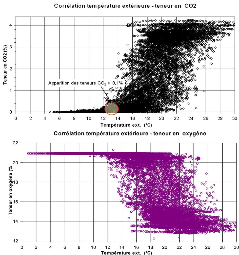
Figure 5. Corrélation entre la température extérieure et les teneurs en O<sub>2</sub> et CO<sub>2</sub> observées dans un orifice du réservoir de Moyeuve-Grande
