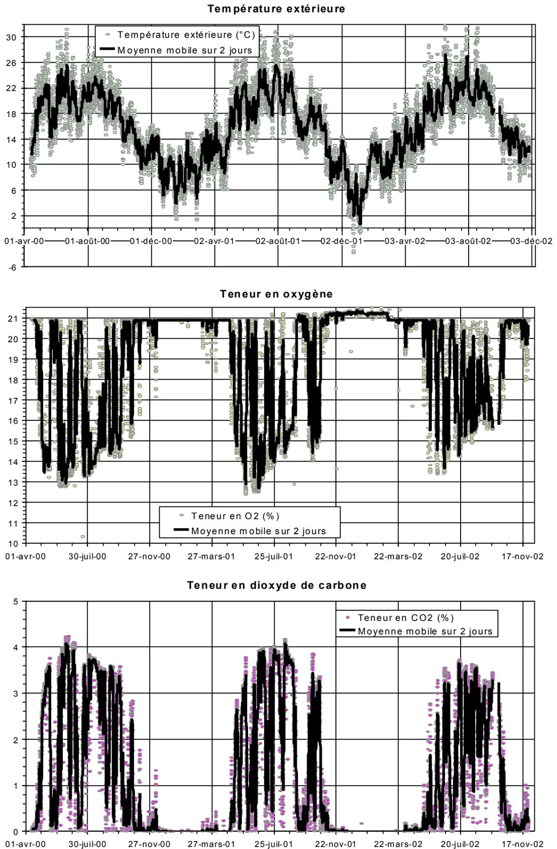
Figure 3. Evolution de la température extérieure et des teneurs en CO<sub>2</sub>, et O<sub>2</sub> observées dans une galerie débouchant du réservoir de Moyeuve-Grande
