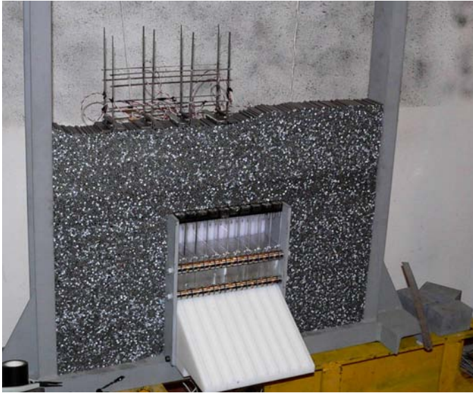
Figure 2. Photo du modèle réduit expérimental (dispositif de création de la cavité en bas au centre, massif de rouleaux de Schneebeli, maquette de bâtiment en surface).
