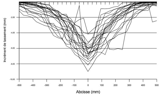
Figure 12: Tassements incrémentaux modifiés pour le front de taille proche d'une structure
