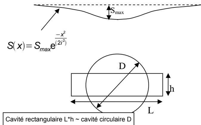
Figure 7: Détermination de la cavité circulaire équivalente
