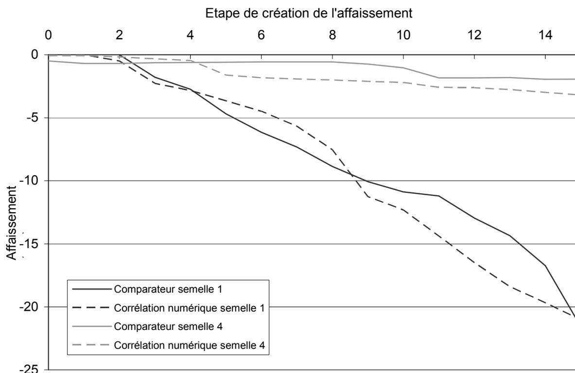
Figure 9 : Comparaison entre les tassements des semelles donnés par les comparateurs et l'imagerie numérique
