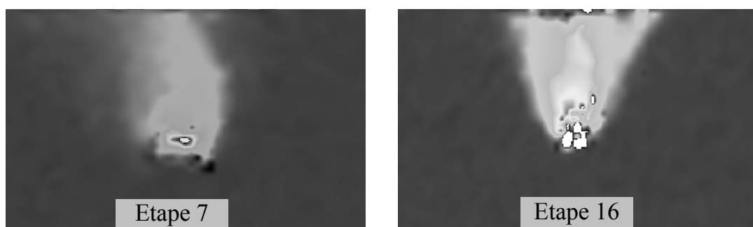
Figure 2 : Deux champs de déformation obtenus par imagerie numérique pour un essai en terrain vierge ( plus le gris est clair plus les déformations sont importantes ).
