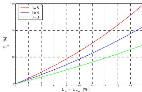
Figure 4. Evolution de l'erreur  $E_\varepsilon$  en fonction de l'erreur  $E_\sigma$ .
