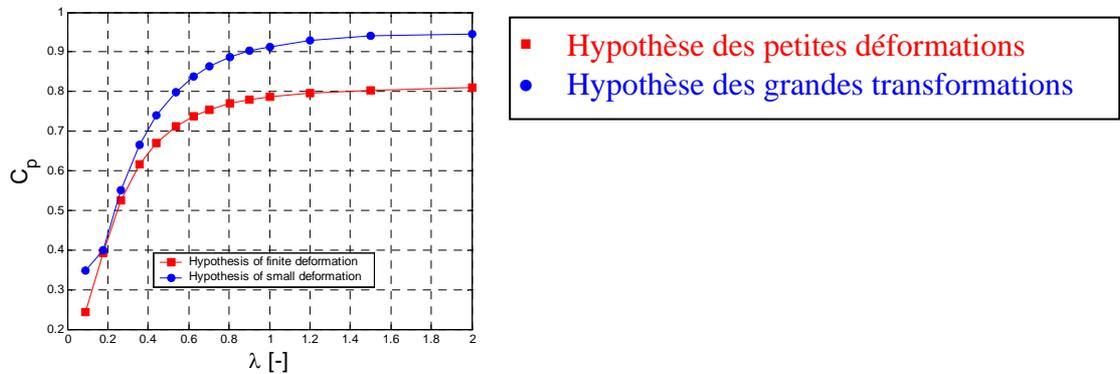
Figure 1. Valeurs du facteur de correction  $C_p$  en fonction de l'élancement  $\lambda$  dans une analyse vis-à-vis du fluage. Valeurs dans le cas de transformation finies et infinitésimales (Laouafa, 2004).
