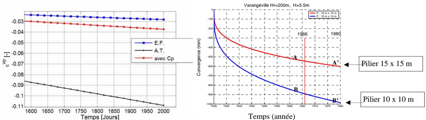
Figure 6. Evolution de la déformation viscoplastique en fonction du temps (gauche) et évolution de la convergence en fonction du temps (à droite), obtenue avec la relation (5) et l'abaque  $C_p(\lambda)$ .
