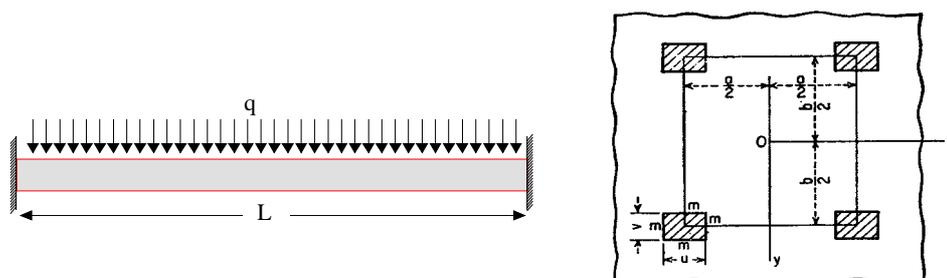
Figure 2 : Schéma d'une poutre doublement encadrée et d'une plaque sur appuis (Timoshenko, 1961).
