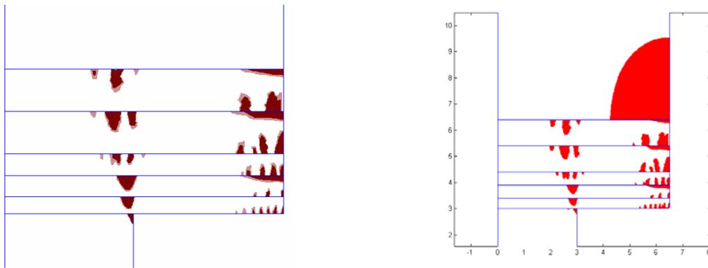
Figure 8 : Galerie de 7 m de largeur : Plasticité (noir) à dans les premiers bancs (gauche) et déformation volumique positive (droite).
