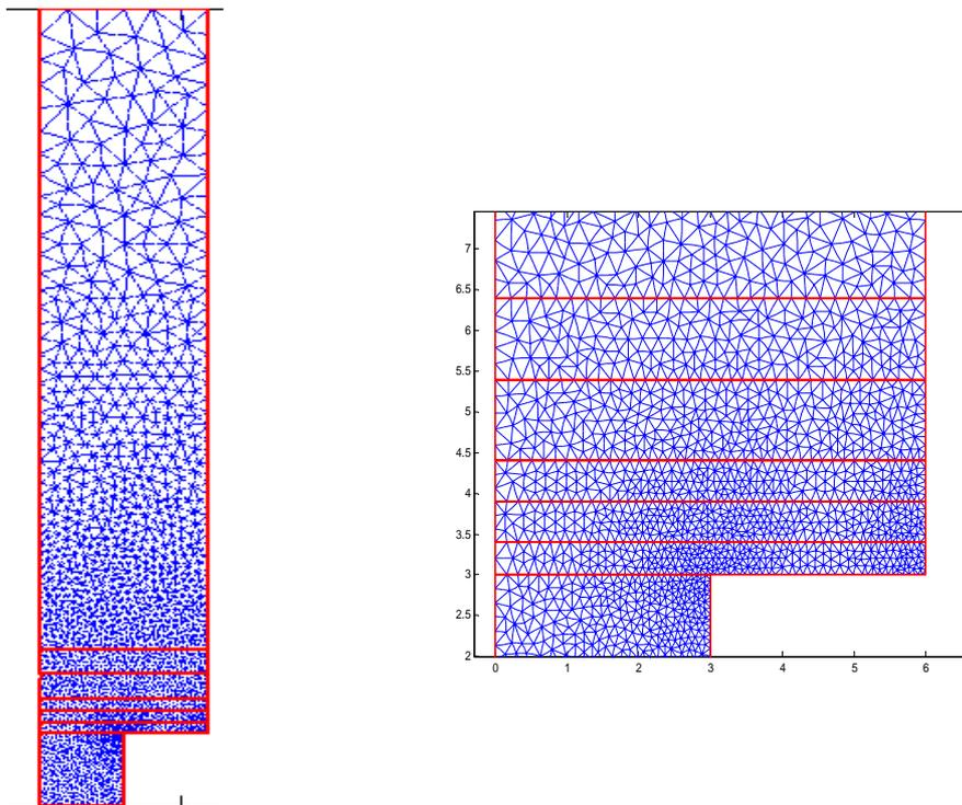
Figure 5 : Maillage du modèle ainsi qu'un « zoom » au voisinage du bas-tôit.
